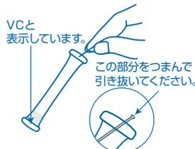
③ チューブ先端のラインを引き抜きます。
