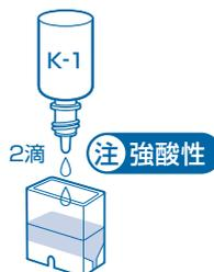
① 検水を専用カップの線 (1.5mL) まで入れ、滴ピンの K-1 試薬を2滴加えます。
