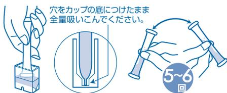
④そのまま穴を検水の中に入れ、つまんだ指をゆるめ、全量吸い込みます。液がもれないようにかるく5~6回振り混ぜます。
