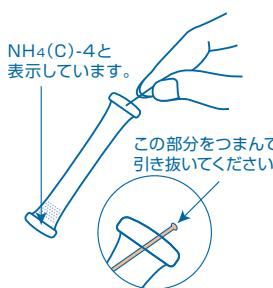
①チューブ先端のラインを引き抜きます。
