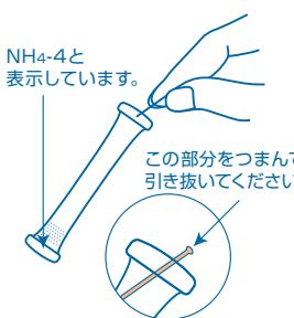
①チューブ先端のラインを引き抜きます。
