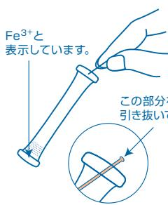
①チューブ先端のラインを引き抜きます。
