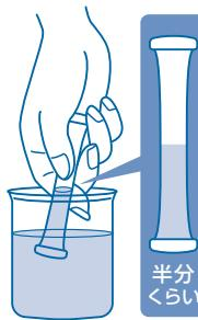
③そのまま穴を検水の中に入れ、つまんだ指をゆるめ、半分くらい水を吸い込むまで待ちます。液がもれないようにかるく5~6回振り混ぜます。
