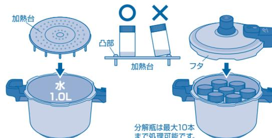
③高圧分解器に加熱台を入れ、1.0Lの水位線まで水を加えます。②の分解瓶の蓋を少し緩め、加熱台の上に置き(磁石により加熱台に吸着します)、高圧分解器のフタを閉めます。
