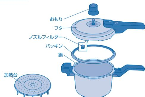
⑩高圧分解器の中に残った水は、弱アルカリ性になっていますのでご注意ください。加熱台は腐食しやすいので、すぐに水道水でよく洗浄してください。鍋・フタ・おもり・パッキン・ノズルフィルターは、外して洗浄してください。分解瓶は、純水でよく洗浄してください。洗浄後は、よく乾燥させてください。
