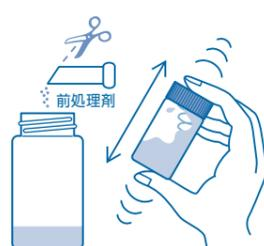
②前処理剤を加えます。分解瓶の蓋を閉め、30秒程度振り混ぜて試薬を完全に溶かします。
