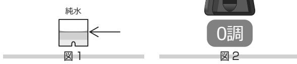
4.専用カップをセルボックスに入れ、【0調】を押します。(図2)
