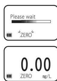
③ 0調ボタンを押します。ゼロ調整終了後、専用カップを取り出します。
