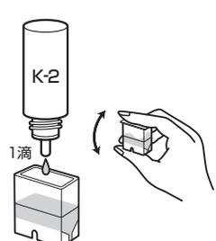
⑥ K-2試薬を1滴加え、蓋をして2~3回振りします。
