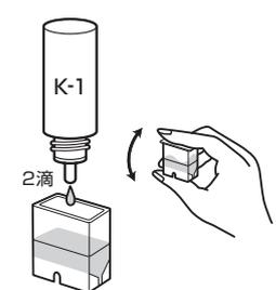
④ K-1試薬を2滴加え、蓋をして2~3回振りします。
