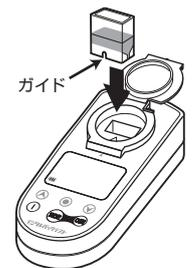
② 長押しで電源を入れ、専用カップのガイドが手前になるように測定部にセットします。
