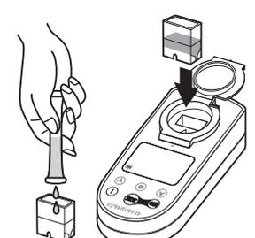
⑬ 専用カップにチューブ内の測定液を静かに戻します。専用カップを測定部に再びセットし、静置します。
