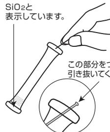
⑧ チューブ先端のラインを引き抜きます。
