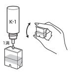
④専用カップ内の検水に、滴ビンの K-1試薬を1滴(約0.04mL)加え、 蓋をして2~3回振ります。
