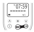
⑧⑦と同時に測定ボタンを押します。 カウントダウンが始まります。
