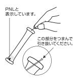
⑤チューブ先端のライン を引き抜きます。
