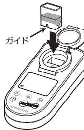
② 長押しで電源を入れ、専用カップのガイドが手前になるように測定部にセットします。
