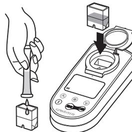
⑨ すぐに専用カップにチューブ内の測定液を静かに戻します。専用カップを測定部に再びセットし、静置します。
