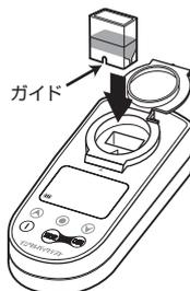
② 長押しで電源を入れ、専用カップのガイドが手前になるように測定部にセットします。
