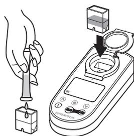
⑨ 専用カップにチューブ内の測定液を静かに戻します。専用カップを測定部に再びセットし、静置します。
