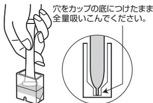
⑥ そのまま穴を検水の中に入れ、つまんだ指をゆるめ、専用カップの検水を全量吸い込みます。
