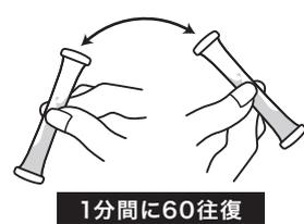
⑧ 検水を吸い込んだチューブを1分間左右に転倒させて振り混ぜます。
