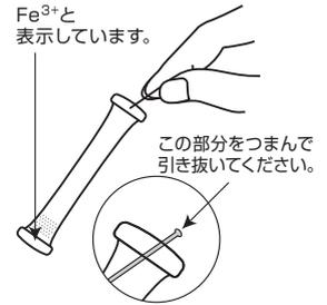
④ チューブ先端のラインを引き抜きます。
