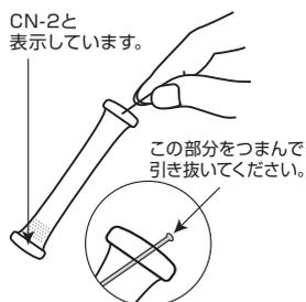
⑤ チューブ先端のラインを引き抜きます。
