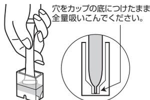
⑦ そのまま穴を検水の中に入れ、つまんだ指をゆるめ、専用カップの検水を全量吸い込みます。
