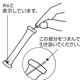
⑧チューブ先端のラインを引き抜きます。
