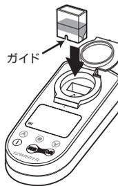
③長押しで電源を入れ、専用カップのガイドが手前になるように測定部にセットします。
